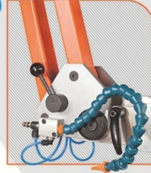
Hava-Yağ karışımı ile yağlama ve soğutma operasyonu için, yüksek verimli yağlama sistemi (isteğe bağlı özelliktir)
