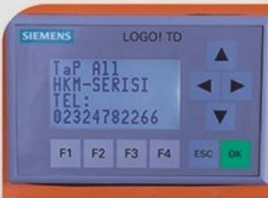
Kompakt ve kullanımı kolay, dijital operatör paneli, pompa basıncı, yağ seviyesi, ileri ve geri dönüş hızı gibi verilerin takip ve kontrolü için tasarlanmıştır.
