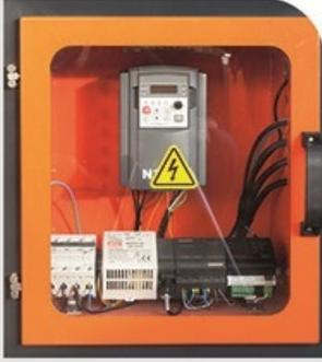
Elektrik panosu, üst sınıf, PLC, İnventör, elektronik seviye ve basınç algılayıcıları ile donatılarak, Makinanın, max. Verimde, min. Enerji sarfiyatı ile çalışmasını sağlar.
