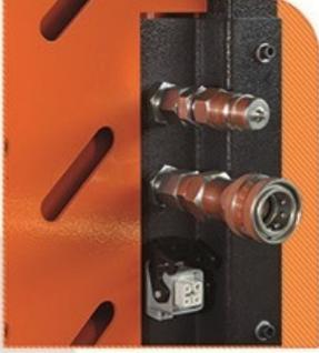
Elektrik ve Hidrolik bağlantıları, hızlı değiştirmeli elemanlar ile donatılmıştır.
