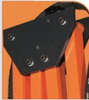
Makinanın alt ve üst kısımlarına yerleştirilmiş, piston kuvvetini ayarlamaya yarayan, ayar mekanizmaları, operatörün makineyi kendi fiziksel şartlarına göre ayarlamasını sağlar.
